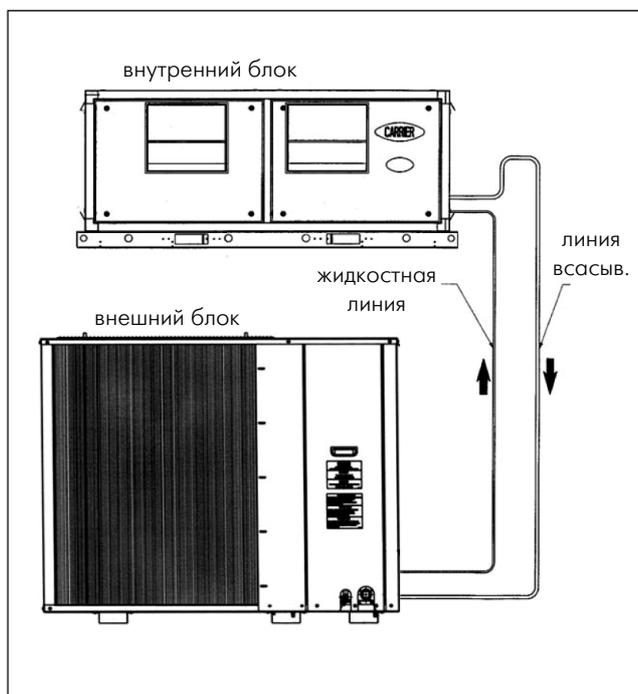
Рис. 6а. Конструкция трубопровода
