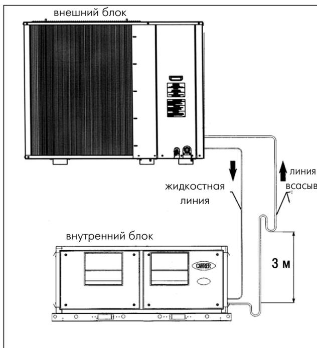
Рис. 6б. Конструкция трубопровода
